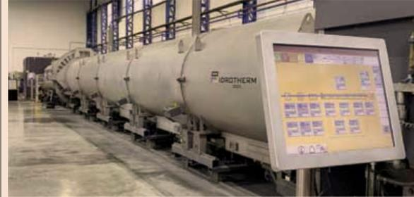
Una linea di estrusione per la produzione di tubi in polietilene in diametri fino a 1200 mm
